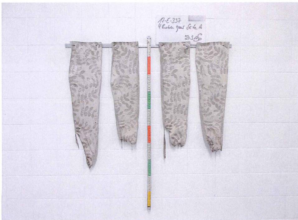
Bild 2: Aussehen der Proben nach dem Brandversuch
