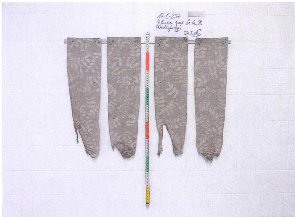
Bild 2: Aussehen der Proben nach dem Brandversuch
