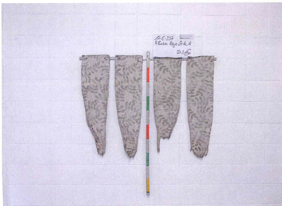
Bild 2: Aussehen der Proben nach dem Brandversuch
